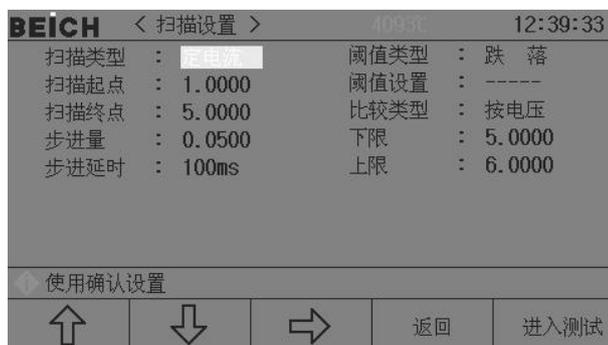
扫描测试，可自行设置扫描的起点与终点及步进量，在扫描的过程中观察一定范围内产品的工作情况，亦可用于捕捉某个突变的信号下参数的临界值，如保护电流，转折电压等。使用扫描测试功能前，在此设定列表测试参数。
