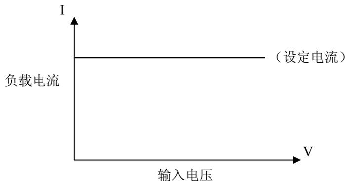
按【定电流】键进入定电流模式，该按键灯亮起，通过数字按键输入需要设定的电流值，输入的数字会在状态栏
